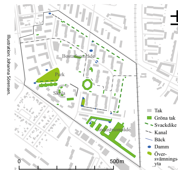
Figur 1. Plan över Augustenborgs dagvattensystem, inklusive gröna tak, svackdiken, rännor, bäckar, dammar och översvämningsytor.
