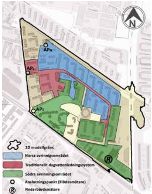
Figur 2 Avrinningsområden i Augustenborg med dräneringssystem; från Haghighatafshar (2019).
